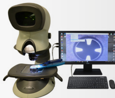
Contrôle alignement des poinçons
