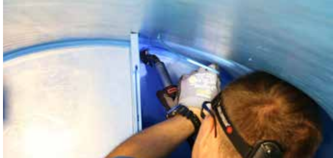
WELDING PEN R combiné à des adaptateurs coudés, des endroits exigus sont également soudables.
